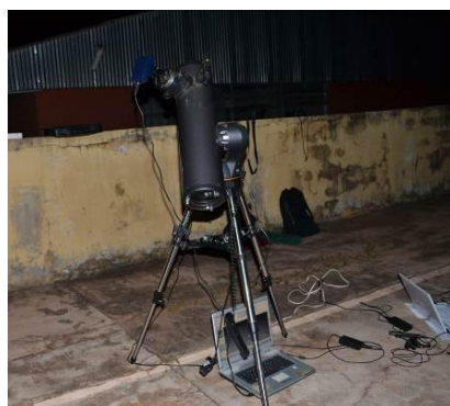
Figura 3: Câmera CDD ligada ao notebook (USB) e acoplada ao telescópio Nexstar 114.
